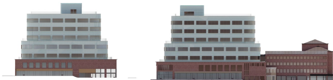
Figur 28. Bilderna visar elevationer av föreslagen bebyggelsen inom Dykaren 17 mot Lilla torget (t.v.) och mot Repslagaregatan (t.h.). Rödbruna delar motsvarar befintlig volym som ska bevaras. (Bild: Sandellsandberg arkitekter)
